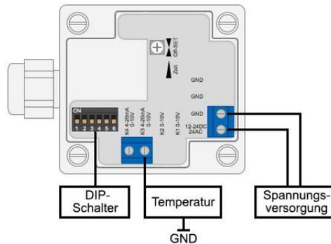
Die Temperaturfühler sind für den Betrieb an (SELV) Schutzkleinspannung ausgelegt. Die in diesem Datenblatt angegebenen techn. Daten sind zu berücksichtigen.
