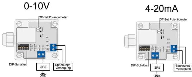
Die Temperaturfühler sind für den Betrieb an (SELV) Schutzkleinspannung ausgelegt. Die in diesem Datenblatt angegebenen techn. Daten sind zu berücksichtigen. Bei Ausführung mit Pt-1000 Sensor in Zweileiter-Ausführung ist der Leitungswiderstand der Anschlussleitung (Zuleitung) zu berücksichtigen. Dieser kann ggf. in der Anzeige- oder Auswertelektronik korrigiert werden.
